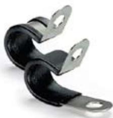
I passacavi sono realizzati con nastro in acciaio inox 430 sagomato e ricoperto in gomma antivibrante, per assicurare e garantire una maggior protezione dei cavi/tubi contenuti nei passacavi stessi e l'assorbimento di eventuali vibrazioni. L'acciaio inox offre un'alta resistenza allo strappo (il punto più critico è nella ridotta superficie della banda intorno al foro di attacco)
